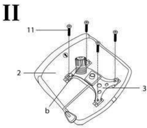
4. Приложите механизм качания (3) к сиденью (2) таким образом, чтобы винт регулировки жесткости качания (b) был направлен к передней части сиденья. Закрепите механизм винтами (11).
